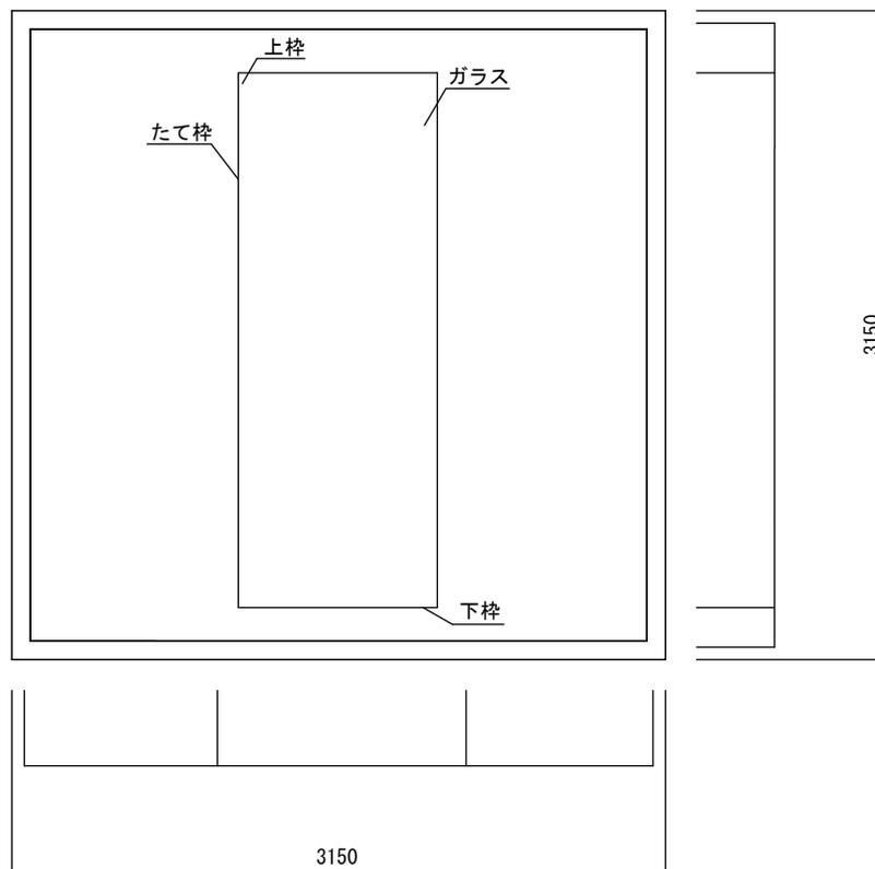
図- \* 試験体の構造・寸法(寸法単位 : mm)
