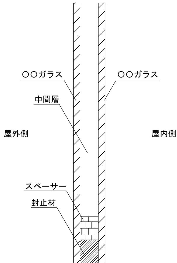
図-\* 試験体の構造・寸法(寸法単位: mm)
