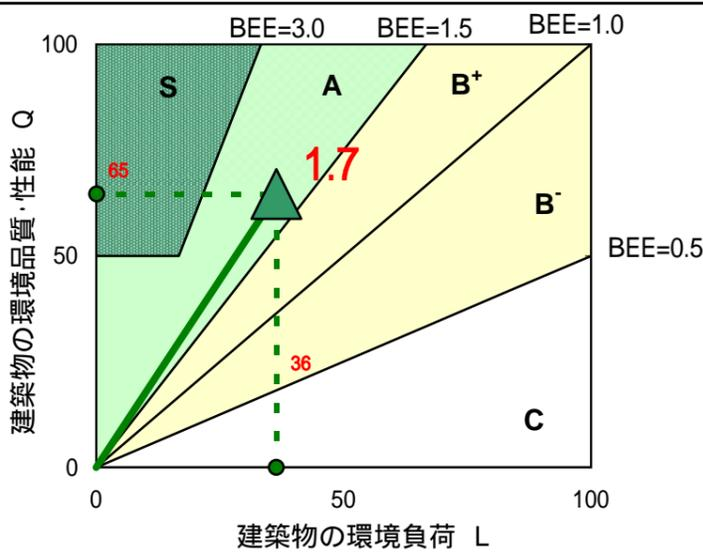
$$BEE = \frac{\text{建築物の環境品質}Q}{\text{建築物の環境負荷}L} = \frac{25 \times (SQ-1)}{25 \times (5-SLR)} = \frac{62.5}{37.5} = 1.7$$
